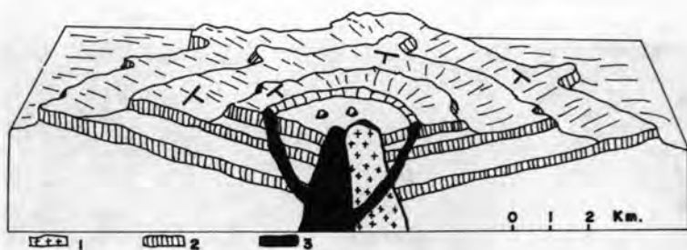
FIGURA 53. Bloque diagrama esquemático del volcán escocés (basado en Derruau, 1956). 1. Roca hipoabisal cristalina intermedia; 2. basalto; 3. basaltos tardíos formando espigones y un dique circular.
