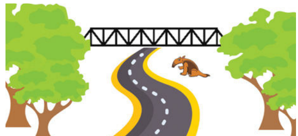
Figura 3. Carretera con curvas pronunciadas aumenta la probabilidad de atropello por lo que recomienda la colocación de pasos de fauna.
