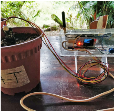
Figura 2. Sistema de medición de humedad implementado. Fuente: Elaboración propia.
