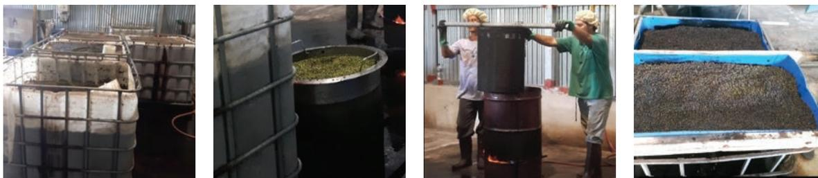
**Figura 1.** Proceso de producción de pimienta negra en la planta de APROPISA. (A) Pimienta verde almacenada en contenedores plásticos con agua. (B) Canastas metálicas con pimienta verde (25 kg) lista para ser escaldada. (C) Introducción y retiro de las canastas metálicas en los contenedores con agua a 80°C. (D) Escurrido de la pimienta tras el escaldado. Fuente: Elaboración propia.
