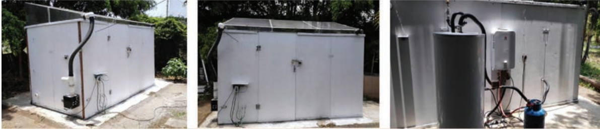
Figura 3. Prototipo de secador solar desarrollado por el grupo de investigación en Sistemas Térmicos Solares para la Agricultura, Sede Regional San Carlos, Instituto Tecnológico de Costa Rica.
