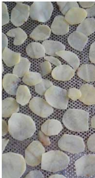
Figura 3. Hojuelas de papa var. Única pre tratadas y listas para el proceso de deshidratación en el sistema térmico solar forzado del DOCINADE (CTLSC-ITCR).
