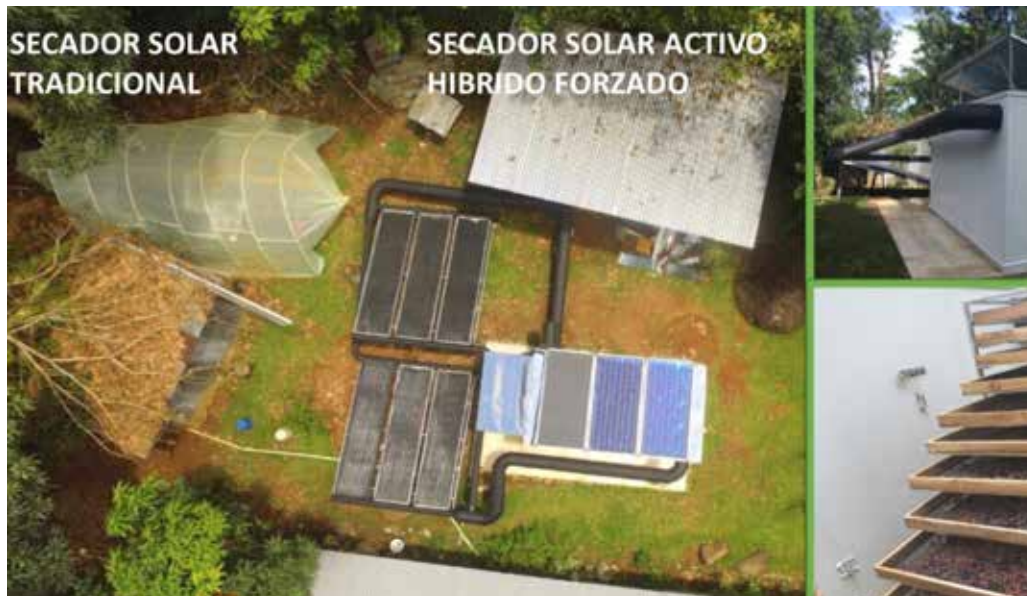
Figura 3. Sistema térmico solar activo híbrido forzado.
