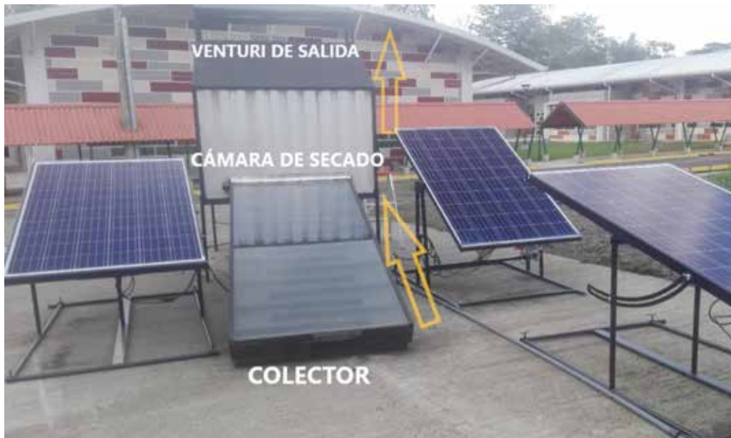
Figura 1. Sistema térmico solar pasivo – híbrido Fuente: Elaboración propia
