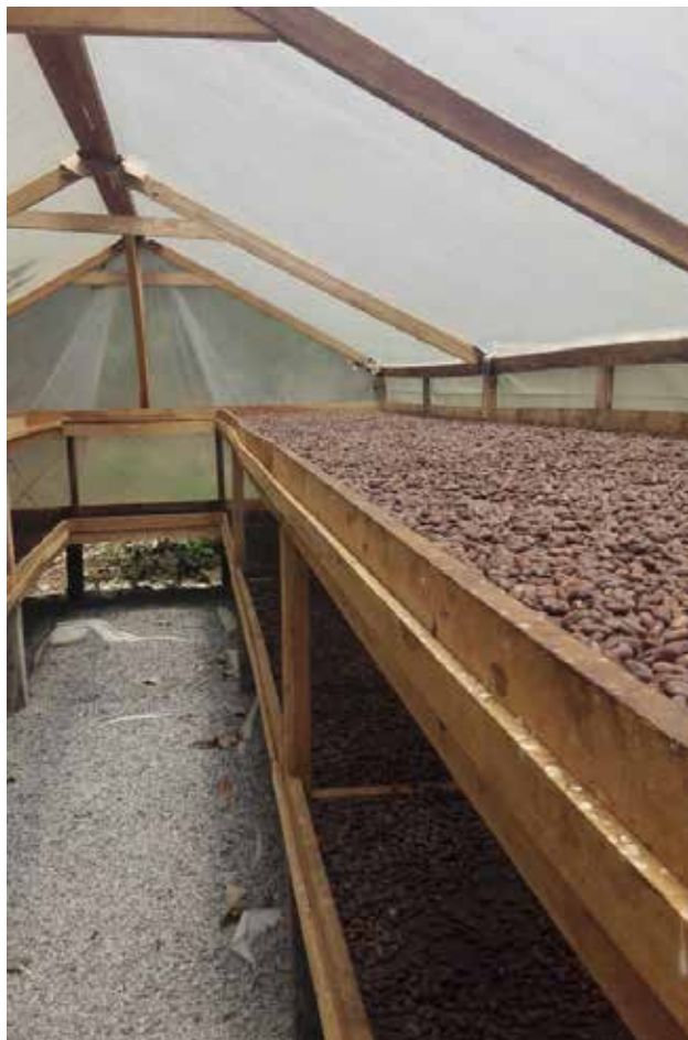
Figura 5. Secado solar tradicional tendido al sol con plástico superior. Fuente: Elaboración propia
