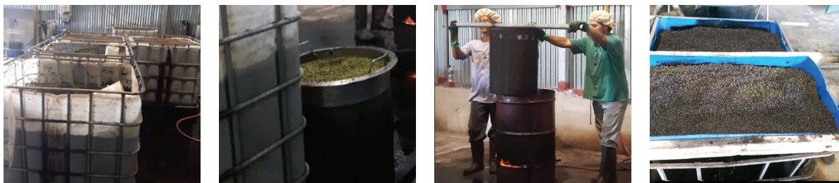
Figura 1. Proceso de producción de pimienta negra en la planta de APROPISA. (A) Pimienta verde almacenada en contenedores plásticos con agua. (B) Canastas metálicas con pimienta verde (25 kg) lista para ser escaldada. (C) Introducción y retiro de las canastas metálicas en los contenedores con agua a 80°C. (D) Escurrido de la pimienta tras el escaldado. Fuente: Elaboración propia.
