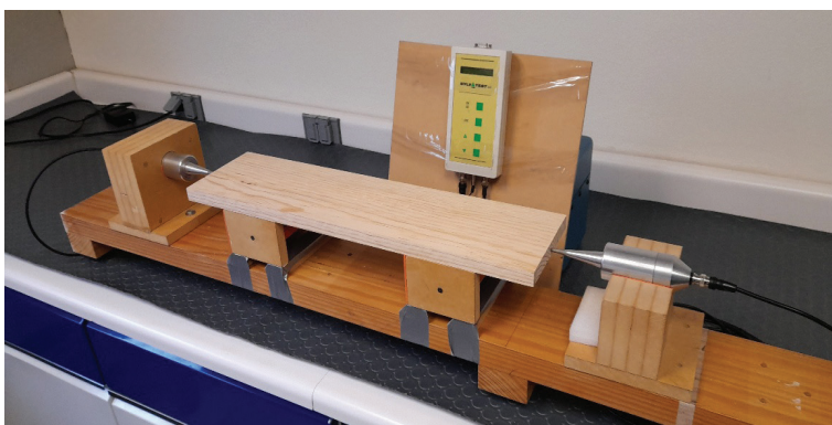
Figura 2. Prueba de ultrasonido en tableros contrachapados.
