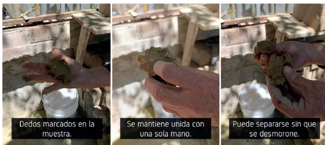
Figura 6. Prueba manual para verificar la cantidad de agua requerida en la hidratación de la tierra más cemento.
