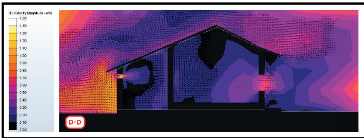
Figura 8. Simulación de viento de la sección D-D de la Casa de la Cultura de Liberia. Autoría propia a partir del software AUTODESK CFD.
