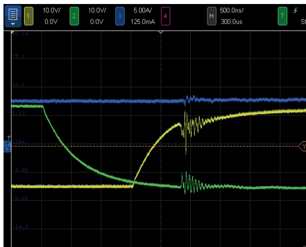
Figura 9. Prueba física de la operación de un medio puente H con 100V y un capacitor entre la puerta-fuente. (10 V/div, 500 ns/div)
