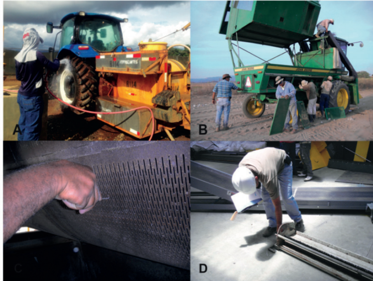
Figura 1. Gestión de Riesgo mediante protocolos de limpieza de equipos y maquinaria utilizados en las labores de manipulación de los Organismos Vivos Modificados en Cañas, Costa Rica. A: Limpieza de las llantas de un tractor con agua a presión; B: Personal realizando la limpieza de una máquina cosechadora; C: Extracción minuciosa de semilla en una deslintadora de algodón; D: Encargado de la planta de equipo utilizado para desmotar algodón; nótese que en su mano tiene un registro. Fotografías de gira de campo del curso Seguridad de la Biotecnología IB-3403 (Bioseguridad) 2023 de la carrera de Ingeniería en Biotecnología del Instituto Tecnológico de Costa Rica, Prof. Giovanni Garro.
