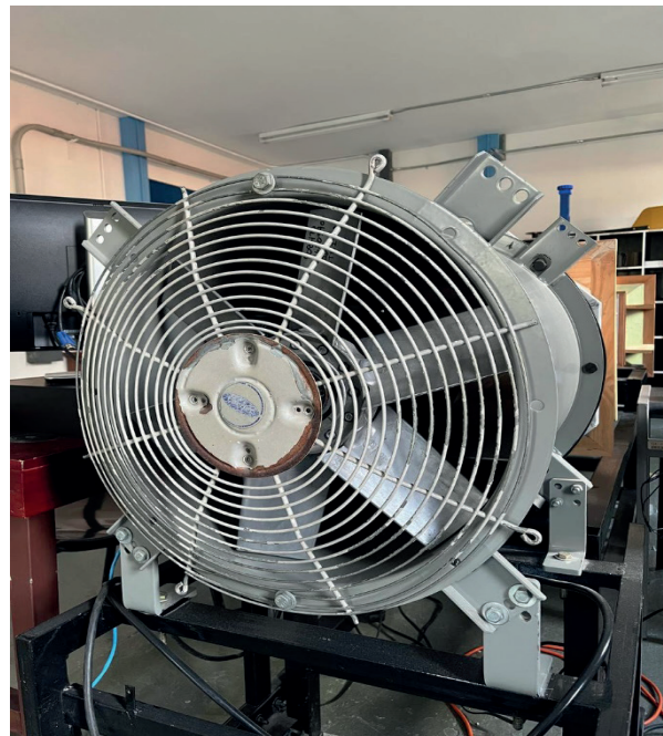
Figura 12. Ventilador axial del túnel de viento del TEC.
