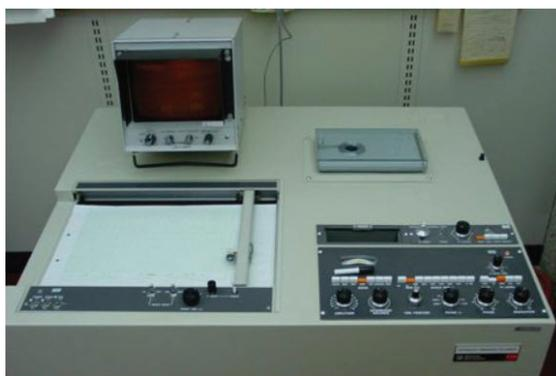
**Figura 4.** Dispositivo Hitachi & Perkin-Elmer R24-B de 60 MHz. Tomado de [95].
