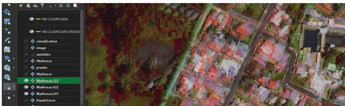
**Figura 2.** Visualización de imagen multiespectral en combinaciones RGB 123, 432, 341 y satélite de Google. Por medio de la herramienta QGIS 3.10.0 (2022).
