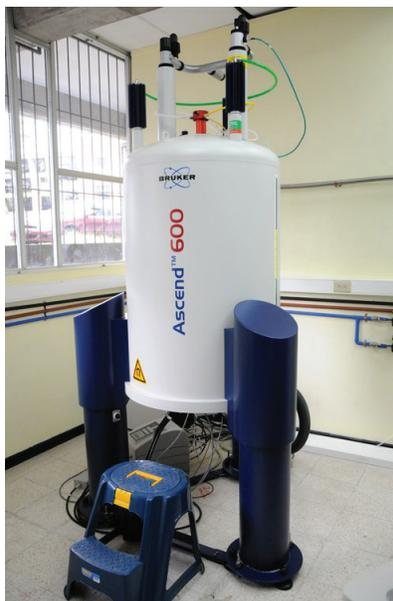
**Figura 8.** Equipo de RMN Bruker Ascend 600, de 600 MHz, ubicado en el CIPRONA. Tomado de [102].
