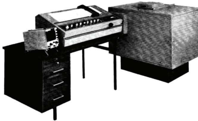
**Figura 2.** Imagen del Perkin-Elmer R12A de 60 MHz, primer modelo de RMN adquirido en el país. Tomado de [91].
