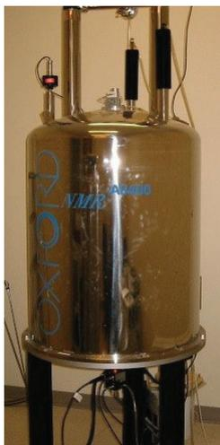
**Figura 6.** Dispositivo de RMN Varian Mercury 400 Plus de 400 MHz, modelo del ubicado en la UCR. Tomado de [99].
