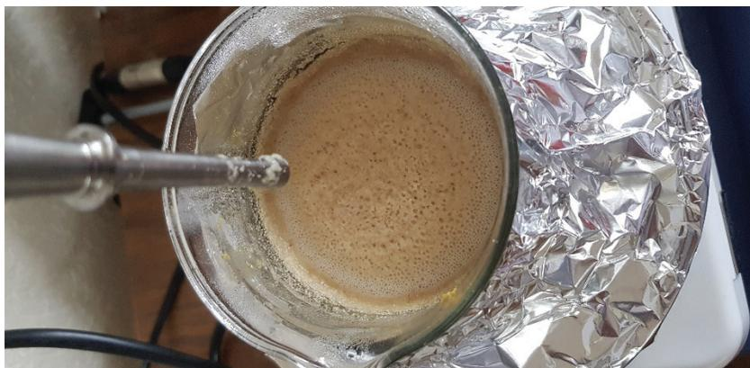
**Figura 2.** Deslignificación asistida por ultrasonido.
