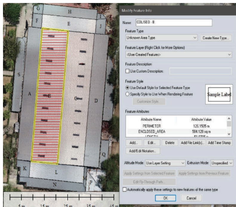
Figura 2. Medición de área de cubierta.
