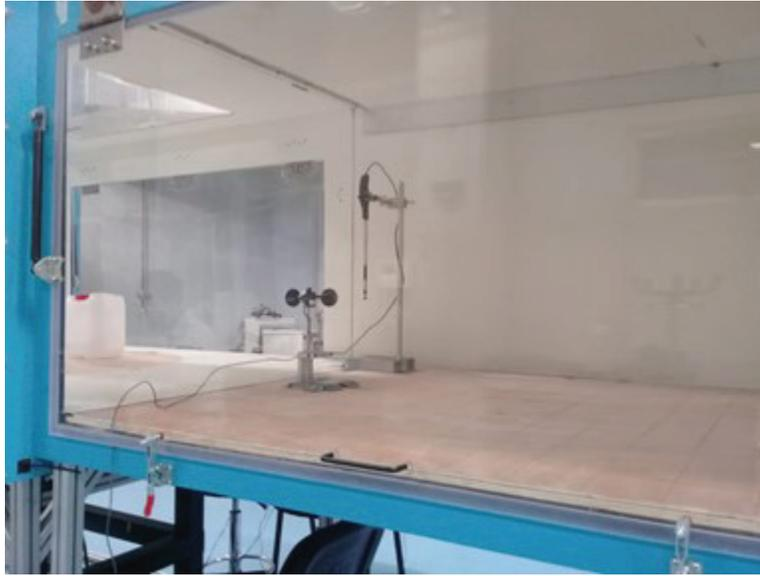
**Figura 5.** Montaje del anemómetro de copas y referencia de anemómetro de hilo caliente, en el túnel de viento de la UCR.
