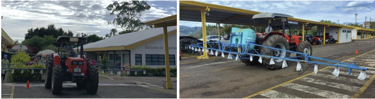
Figura 5. Recolección de volumen de cada boquilla de la pulverizadora en estudio.
