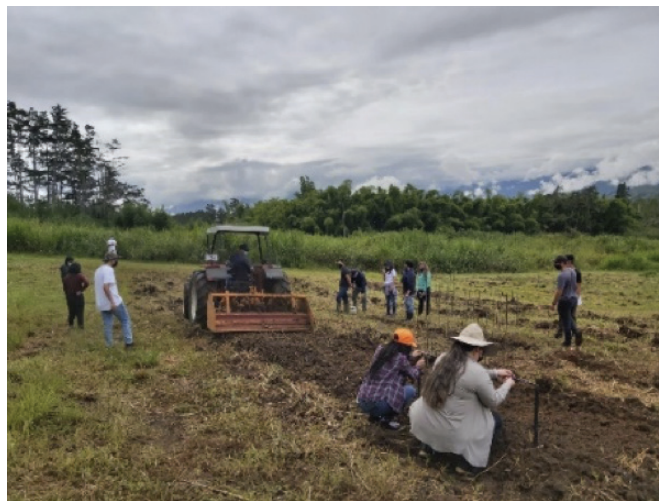
Figura 3. Medición de la profundidad de labranza y velocidad de avance.
