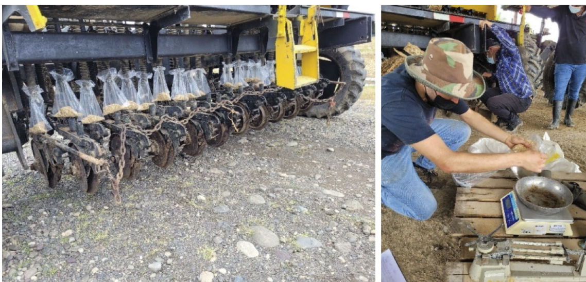
Figura 4. Medición de la cantidad de semilla por cada chorro de la sembradora en estudio.
