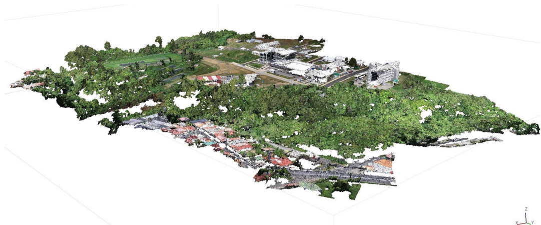
Figura 6. Nube densa de puntos generada en Agisoft Metashape. (524 896 075 puntos).
