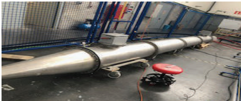
Figura 7. Vista externa del banco de ensayos de DP compuesto por GIL-cable-AIS.
