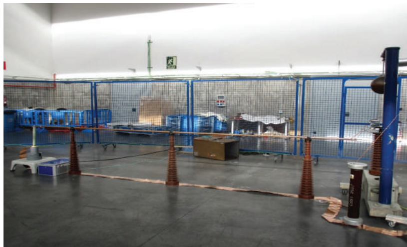
Figura 14. Fotografía tomada en el laboratorio durante los ensayos de inmunidad frente a campo eléctrico efectuados al “RUAT”.
