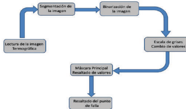
Figura 6. Proceso de digitalización de la imagen termográfica.
