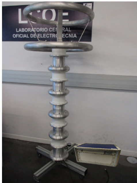
Figura 3. Divisor de alta tensión con el “RUAT” conectado en la rama de baja tensión.
