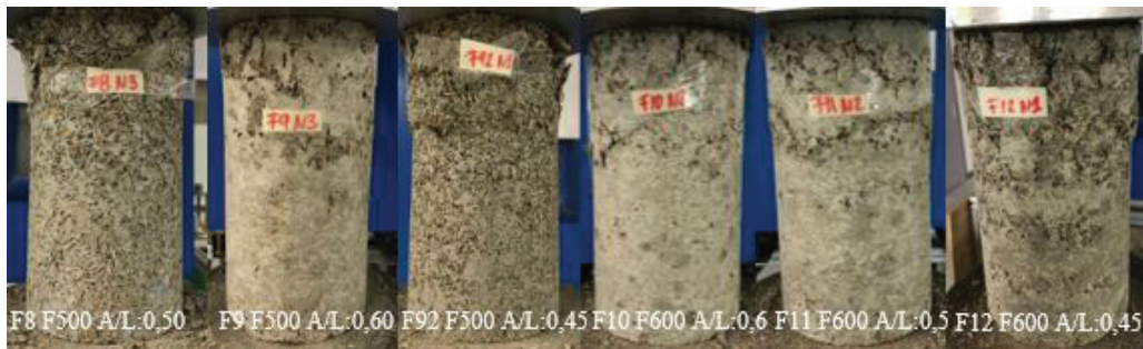
Figura 6. Ejemplo de falla típica presente en los cilindros del grupo de formulaciones F500 y F600.
