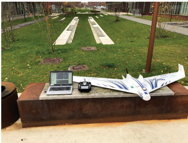
Figura 3. Sistema UAS de izquierda a derecha: Computadora, radio control y Opterra 2m.
