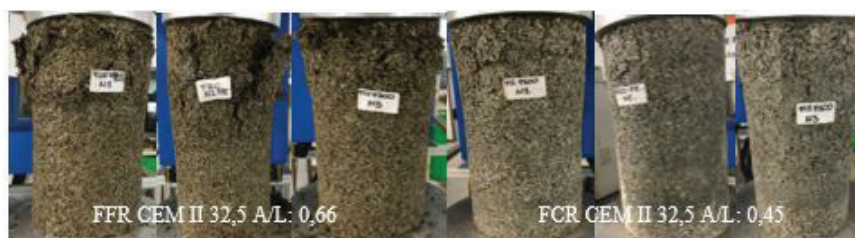
Figura 9. Cilindros de las formulaciones FFR y FCR en la parte superior antes del ensayo de resistencia a la compresión a 7 días y en la parte inferior ya ensayados.
