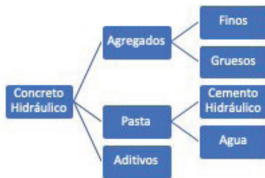
Figura 1. Diagrama de componentes del concreto hidráulico.
