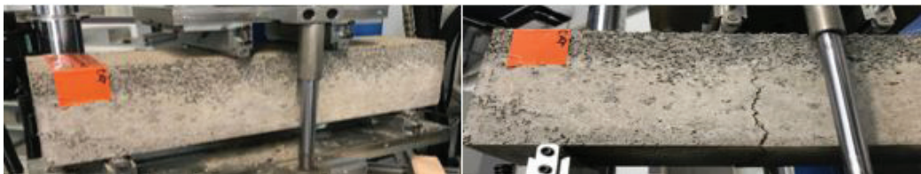
Figura 12. Prisma de bio-concreto formulación FCR (F600 CEM II 32,5 A/L: 0,45) lado izquierdo antes del ensayo de flexión lado derecho después del ensayo de flexión.
