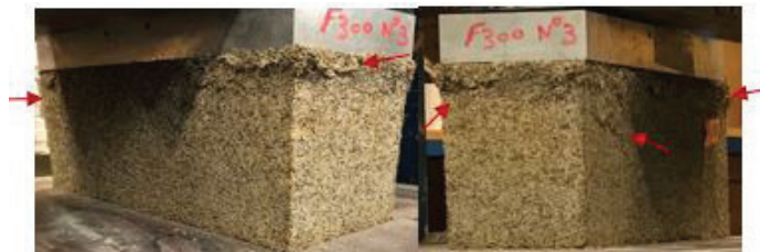
Figura 19. Bloque 3 de la formulación FFR F300 CEM II 32,5 A/L: 0,66 después del ensayo de compresión y las grietas visibles por la falla del espécimen.
