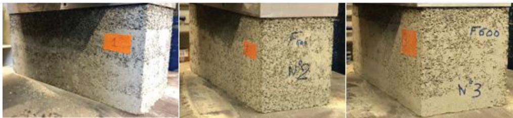
Figura 14. Bloques 1, 2 y 3 de la formulación FCR F600 CEM II 32,5 A/L: 0,45 antes del ensayo de compresión.
