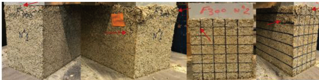
Figura 18. Bloque 1 y 2 de la formulación FFR F300 CEM II 32,5 A/L: 0,66 después del ensayo de compresión y las grietas visibles por la falla del espécimen.
