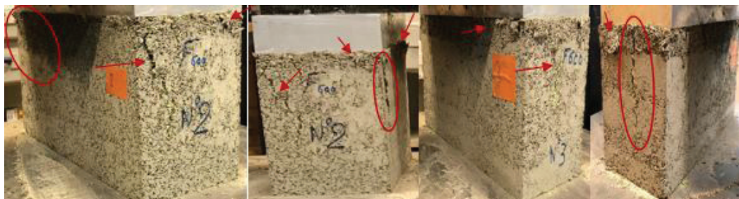
Figura 16. Bloque 2 y 3 de la formulación FCR F600 CEM II 32,5 A/L: 0,45 después del ensayo de compresión y las grietas visibles por la falla del espécimen.
