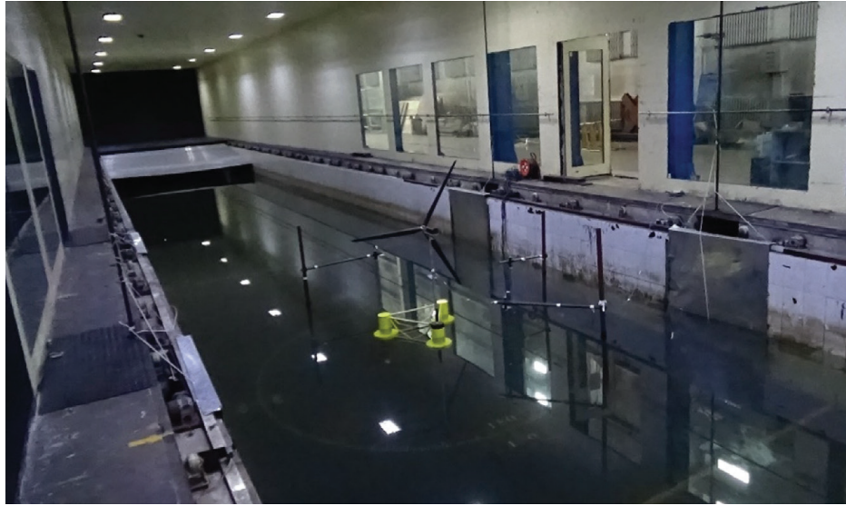
Figura 7. Túnel de viento y canal de olas del Harbin Institute of Technology . Fuente: [65].
