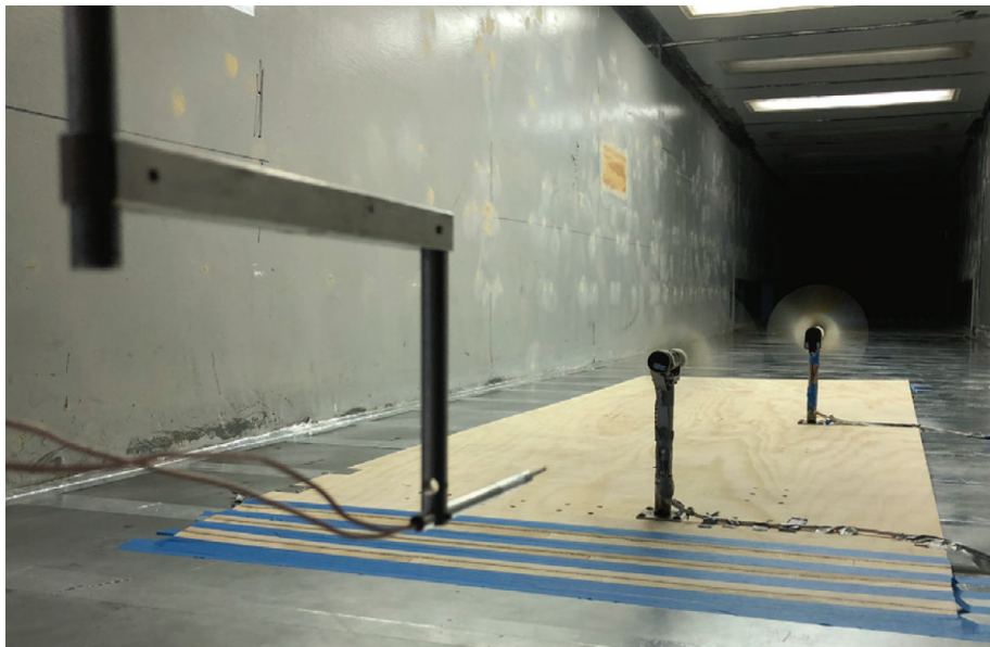
Figura 9. Prueba de dos HAWT en el túnel del St. Anthony Falls Laboratory . Fuente: [18].
