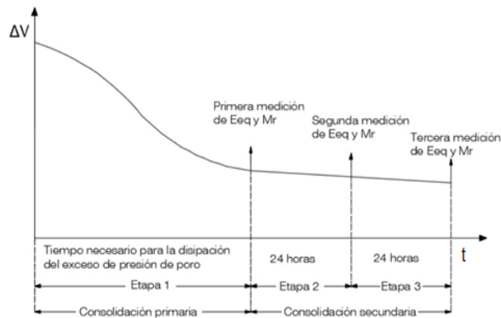
Figura 6. Descripción del proceso de consolidación y medición de los módulos para cada uno de los esfuerzos efectivos aplicados.
