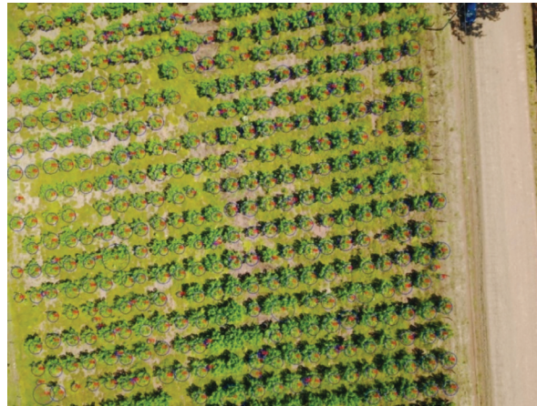
Figura 2. Conteo de árboles de Melina de 5 meses de edad por medio de una interpretación algorítmica de una ortofoto tomada con un dron Mavic Pro, Los Chiles, Costa Rica.
