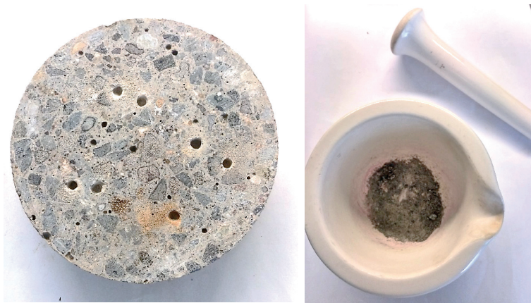
Figura 7. Extracción y preparación de las muestras para análisis con difracción de rayos X y TGA.
