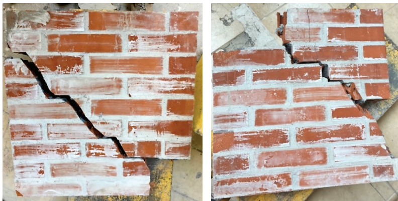
Figura 13. Modos de falla observados, falla por tracción diagonal (Izq.) y falla combinada (Der.).
