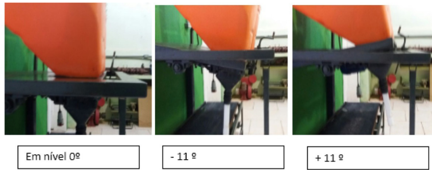
Figura 1. Inclinações de trabalho do dosador de rosca helicoidal dupla nos testes.
