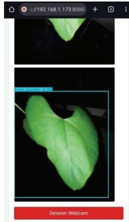
Figura 1. Detección en Tiempo Real con Visión Artificial. Visualización del sistema en ejecución identificando una hoja de poroto mediante la cámara web del usuario. El modelo de visión artificial (YOLOv11) enmarca y etiqueta el objeto detectado, mostrando el nombre de la clase y su nivel de confianza [6], [7], [18].
