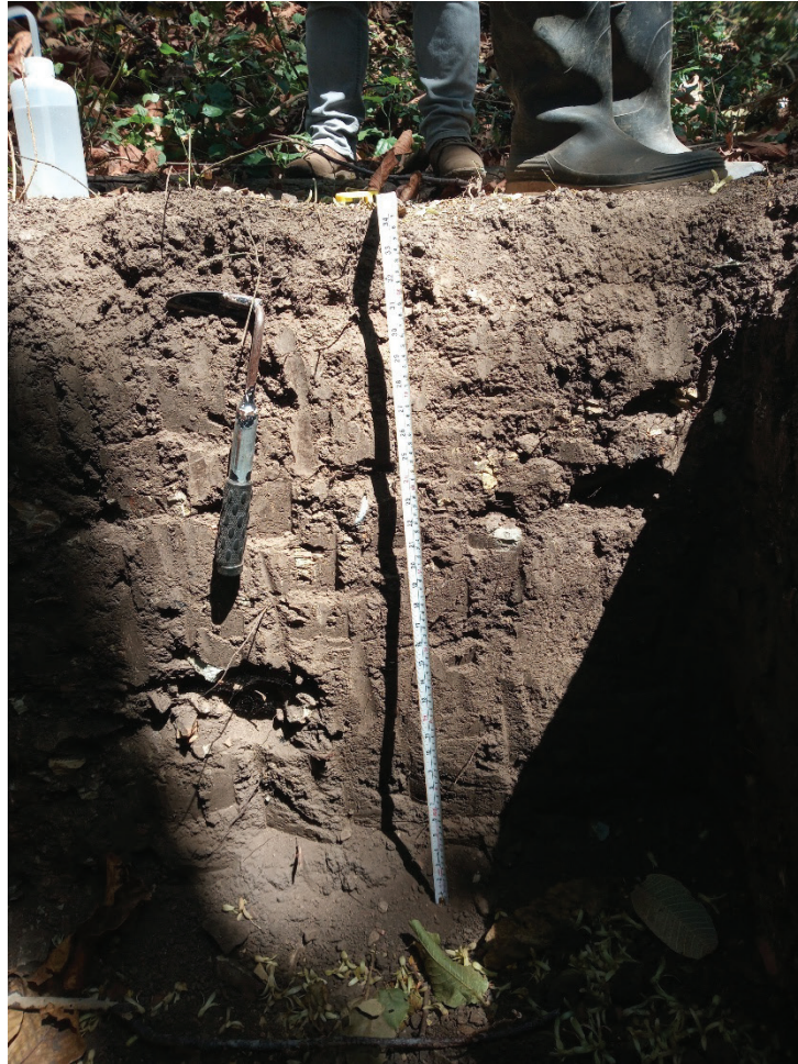
Figura 2. Detalle de una calicata con depósitos del cuaternario, correspondientes a materiales sedimentarios y volcánicos durante el Paleógeno y Neógeno.
