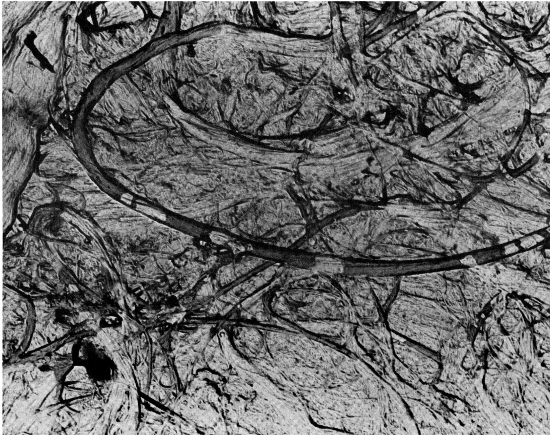
FIG. No. 1 Fotografía al microscopio de transmisión electrónica de papel fino para escritura. (4.000 x).
