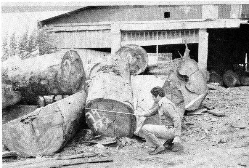
Se muestran unas trozas destinadas a la obtención de piezas para uso estructural. La troza que se mide es Pílón ( Hieronyma alchorneoides ).
