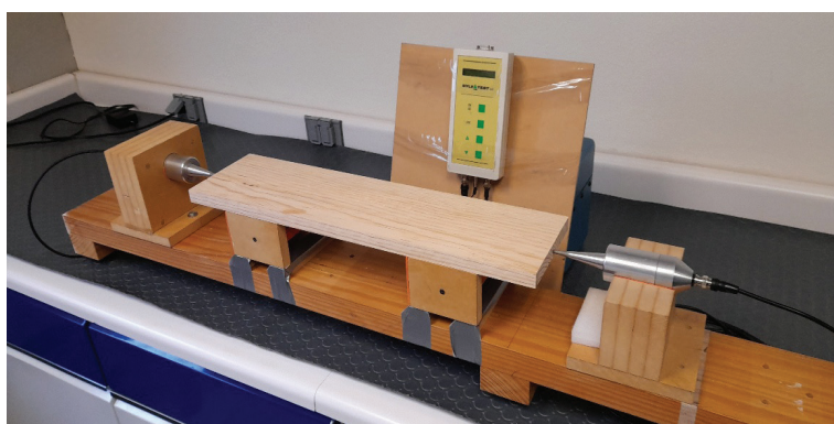
Figura 2. Prueba de ultrasonido en tableros contrachapados.
