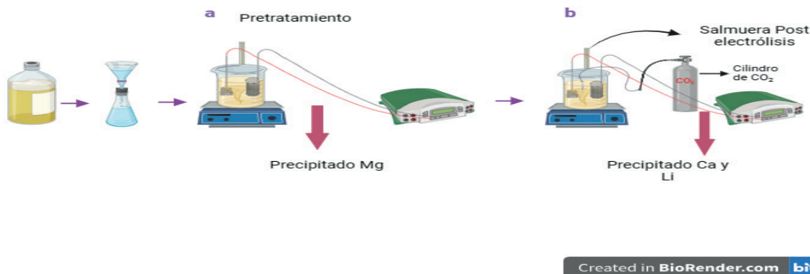
Figura S3. Configuración del sistema de electrólisis para la precipitación de calcio, magnesio y litio a partir de salmueras.
