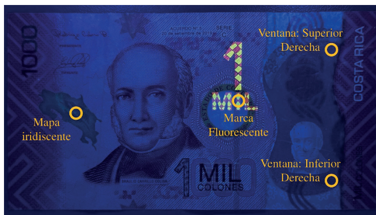
Figura 3. Identificación de las marcas en el billete de mil colones donde se realizaron las mediciones de los espectros infrarrojos.
