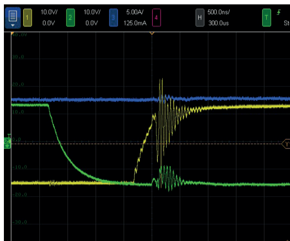
Figura 8. Prueba física de la operación de un medio puente H con 100V. (10 V/div, 500ns/div)
