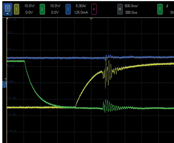
Figura 10. Prueba física de la operación de un medio puente H con 100V, un capacitor entre la puerta-fuente y una resistencia con diodo en el Gate-on y Gate-off. (10 V/div, 500ns/div)
