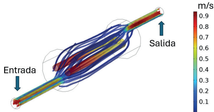
Figura 5. Circulación del agua en el calentador, considerando que la velocidad de entrada del agua es de v = 0.57 m/s.
