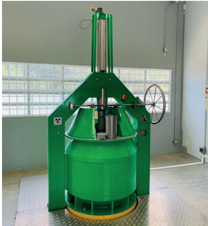
Figura 2. Sistema de irradiación gamma tipo Ob-Servo Ignis del Laboratorio de Irradiación Gamma del Instituto Tecnológico de Costa Rica (ITCR).
