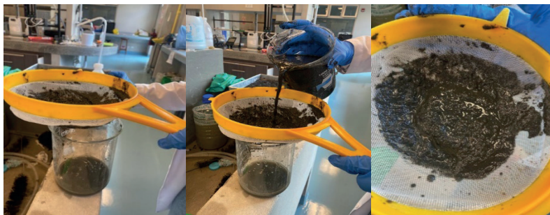
Figura 3. Tamizado del lodo anaeróbico antes de la inoculación de los reactores de laboratorio
