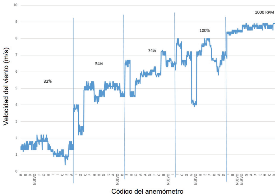
Figura 4. Velocidades medidas por los anemómetros Davis con el ventilador axial y centrífugo.
