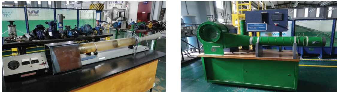
Figura 1. Túneles de viento de viento: axial (izquierda) y centrífugo (derecha)
