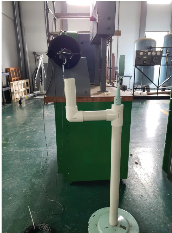
Figura 3. Anemómetro Inspeed siendo probado en el túnel de viento centrífugo.
