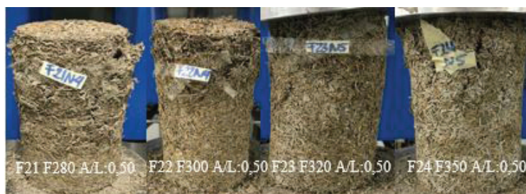
Figura 8. Ejemplo de falla típica presente en los cilindros del grupo de formulaciones F280, F300, F320 y F350.
