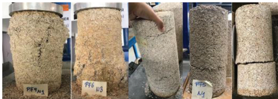
Figura 4. Cilindros de bio-concreto formulaciones F4 y F6 (ligante Cal Natural) ensayados a la resistencia a la compresión a los 28 días y cilindros de formulación F5 (lado izquierdo) fracturados.
