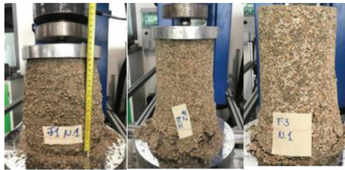
Figura 3. Cilindros de bio-concreto formulaciones F1 a F3 (ligante CEM II 32,5) ensayados a la resistencia a la compresión a los 28 días.
