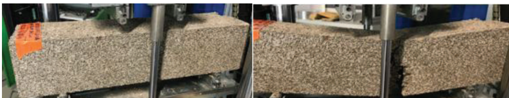
Figura 13. Prisma de bio-concreto formulación FFR (F300 CEM II 32,5 A/L: 0,66) lado izquierdo antes del ensayo de flexión lado derecho después del ensayo de flexión.
