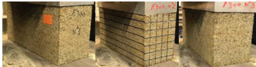
Figura 17. Bloques 1, 2 y 3 de la formulación FFR F300 CEM II 32,5 A/L: 0,66 antes del ensayo de compresión.
