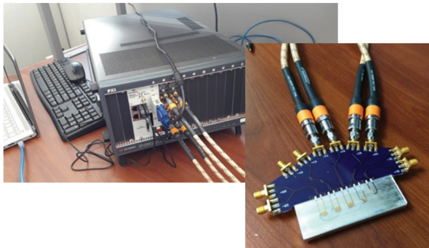
Figura 7. Sistema integrado para medición de espectroscopía por medio del VNA.
