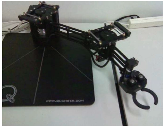
Figura 2. Planta física del 2DoF Manipulador Quanser [10].
