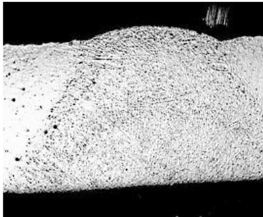
**Figura 3.** Soldadura en tubo capilar sin atacar, 50x.
