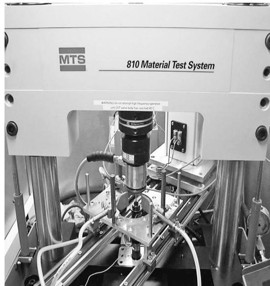
**Figura 1.** Máquina de ensayos de fatiga MTS 810 (Stöcker, 2013).
