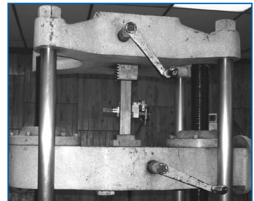
Figura N.º 2. Probeta de madera de melina UD, lista para ser ensayada en la máquina universal de ensayos del CIIBI.
