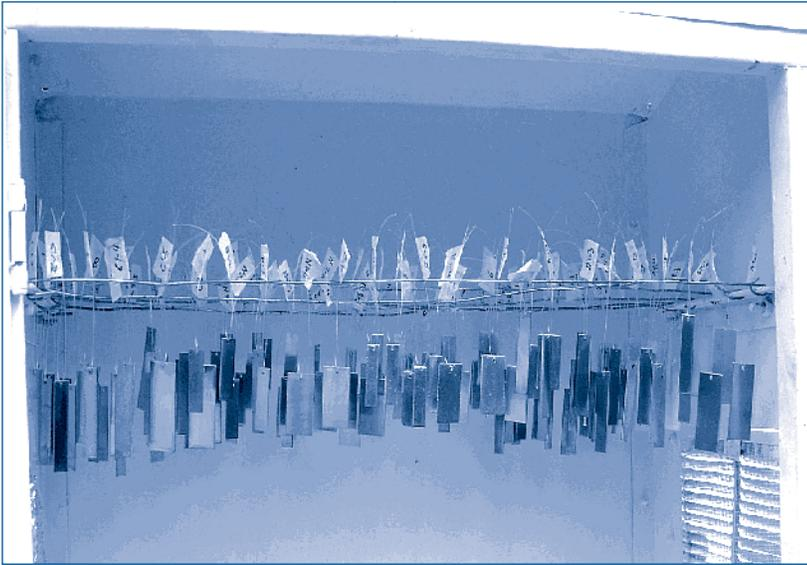
Figura 2. Exposición de probetas en condiciones indoor.
