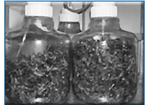
Figura 5 Fotografía del Biorreactor de Inmersión Temporal (BIT) : desarrollado por el Centro de Bioplasmas en La Habana, Cuba.
