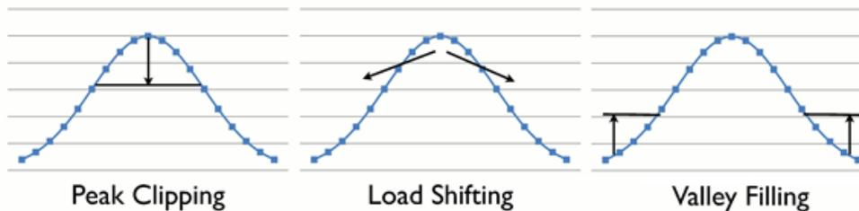
Figura 6. Técnicas para la gestión de la carga (Gellings et al., 2008)
