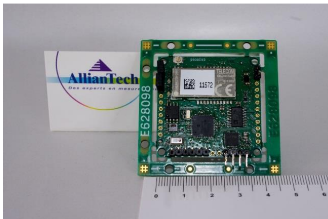
Figura 2. Versión 2 del M32 sobre un circuito de 4 capas (dimensión: 4 cm x 4 cm, sin tomar en cuenta el marco externo PCB, que mide 1 cm).
