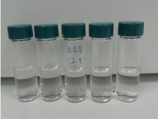
**Figura 130.** Agua residual amarilla tratada a diferentes valores de pH, 7 V, y NaCl: 2.5 g/L y 60 min de electrolisis.
