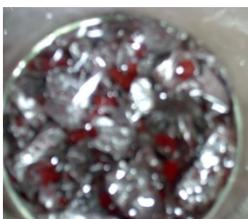
**Vaso D:** En este ensayo también se observa que queda aluminio sin reaccionar y que se forma la misma cantidad de cobre metálico. El  $\text{Cu}^{2+}$  sigue limitando la reacción. La disolución queda incolora. No queda  $\text{Cu}^{2+}$  sin reaccionar
