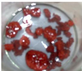
**Vaso C:** Se forma la misma cantidad de cobre metálico que en el vaso B y queda sin reaccionar una menor cantidad de aluminio que en el vaso anterior. Ahora la relación es 1:1 en moles, pero como lo indica la ecuación química por cada dos moles de aluminio se requieren tres moles de la sal de cobre, por esta razón, la sal de cobre se termina y la disolución queda incolora.
