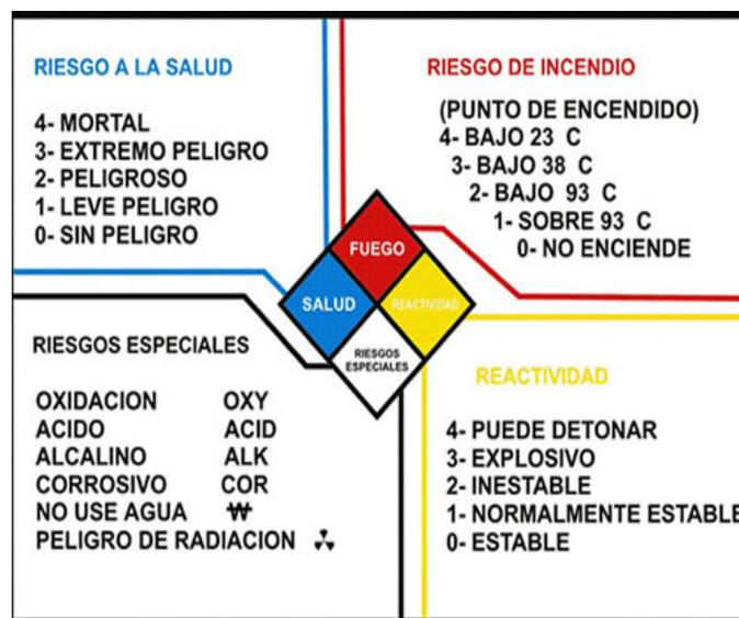
Figura 118. Rombos de seguridad utilizados para identificar riesgos en un laboratorio químico.
