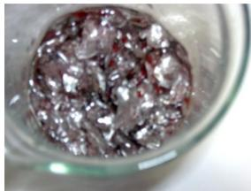
**Vaso B:** Se forma una pequeña cantidad de cobre metálico y permanece sin reaccionar casi todo el aluminio. Se tienen las misma relación de masas (1:1) de ambos reactivos, pero en moles se nota que hay 6 veces más aluminio que  $\text{Cu}^{2+}$ , siendo éste el reactivo que limita la reacción, por lo cual ya no queda  $\text{Cu}^{2+}$  incolora y queda Aluminio sin reaccionar. que para desecharlo se enjuaga, se filtra y se seca para reutilizarlo
