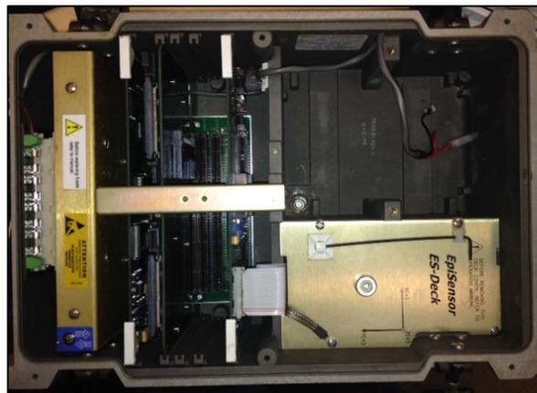
**Figura 13** Acelerómetro, compuesto por grabadora y sensor triaxial
