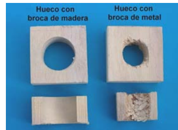
Calidad superficial -externa e interna- producida por dos tipos de brocas en madera de melina.
